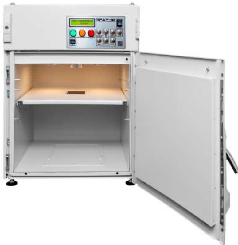
Рис. 5: Установка для контроля зерна (в передвижной рентгенозащитной камере)
